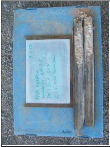
Assaig SPT realitzat entre 2.0 a 2.05 m.
