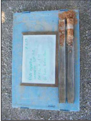
Assaig SPT realitzat entre 4.0 a 4.2 m.
