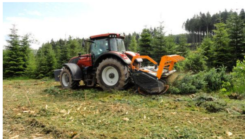
Trituradora forestal reforçada per triturar vegetació i pedres
