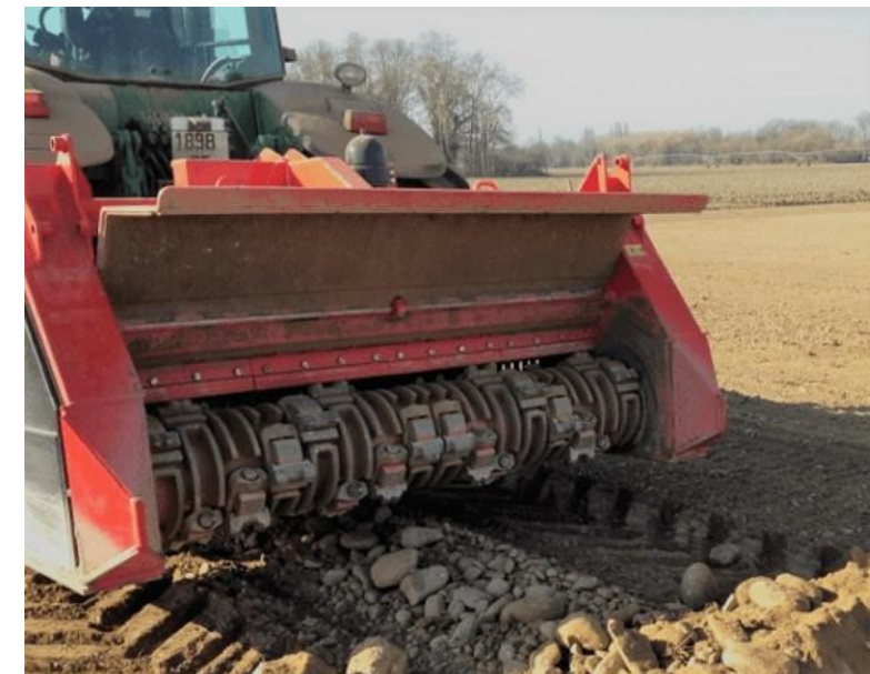
Trituradora de pedres amb detall del rotor.
