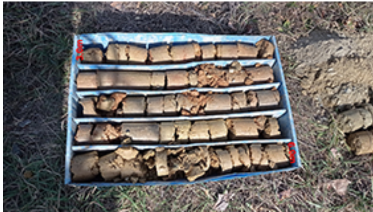
Foto 6: Materials extrets al sondeig S2.1371-24 entre -3,00 i -6,00 m
