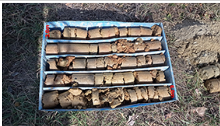
Foto 3: Materials extrets al sondeig S1.1371-24 entre -3,00 i -6,00 m
