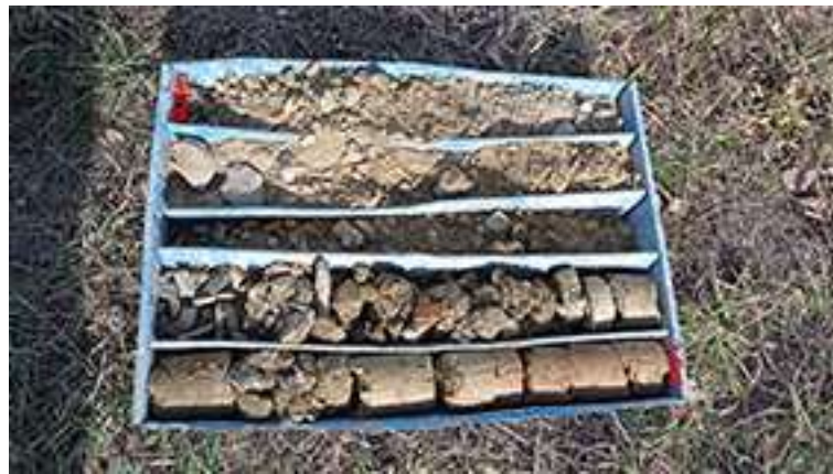
Foto 2: Materials extrets al sondeig S1.1371-24 entre 0,00 i -3,00m
