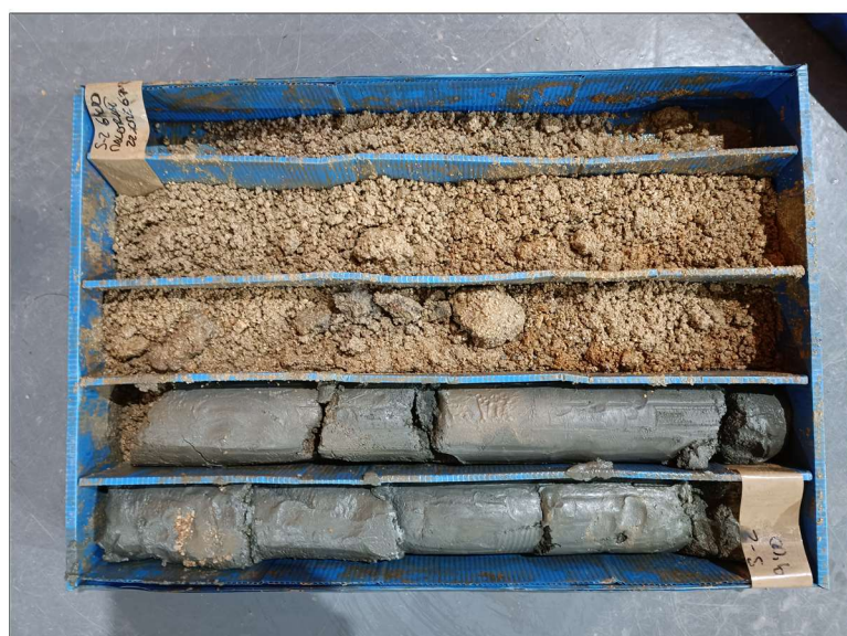
Foto 9: Material perforat entre 6 m i 9 m a S2.
