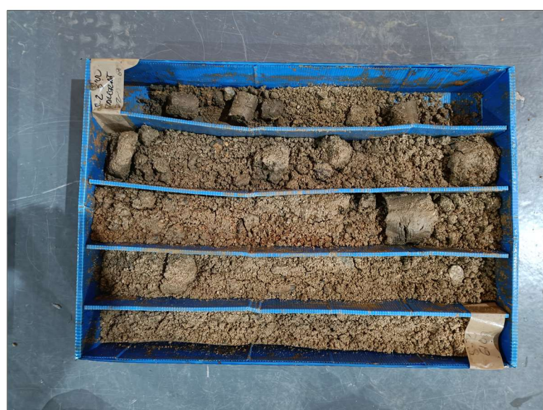
Foto 8: Material perforat entre 3 m i 6 m a S2.
