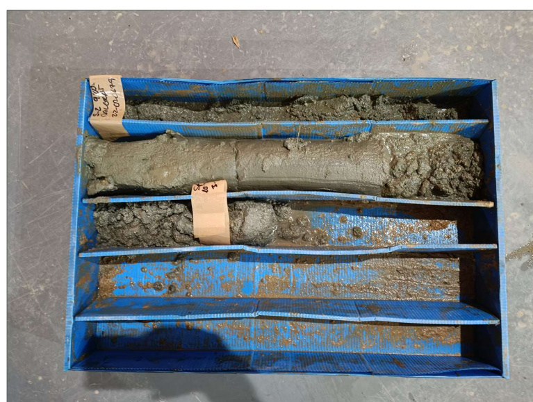
Foto 10: Material perforat entre 9 m i 11 m a S2.
