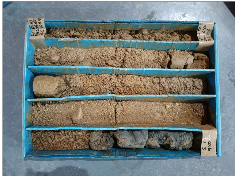
Foto 5: Material perforat entre 6 m i 9 m a S1.
