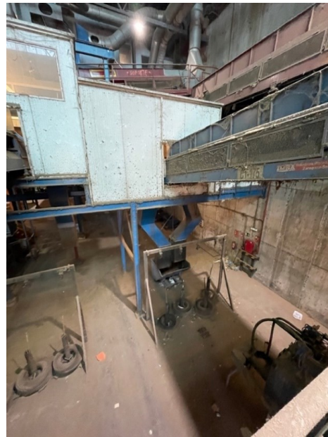
Figura 16. Cabina de control de qualitat manual CB-183, contenidor d'impropis (situat sota la cabina) i Cinta CT-175 d'alimentació a la premsa.
