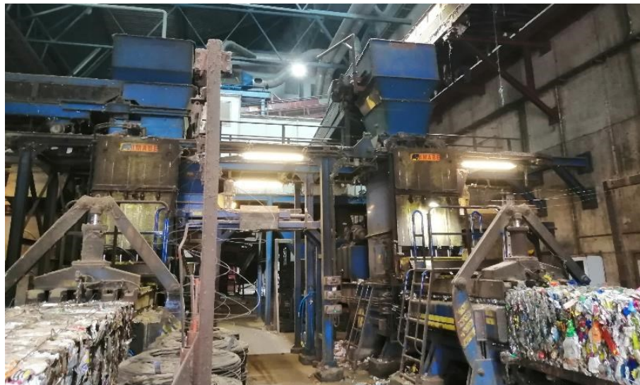
Figura 9. Imatge de les dues premses multi-material disposades en paral·lel i interconnectades per una cinta transversal d'alimentació.
