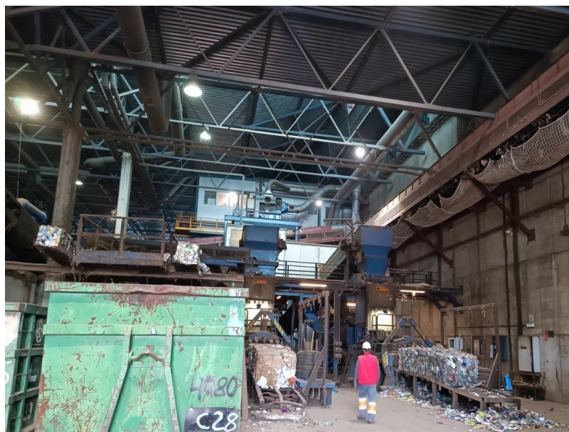
Figura 10. Vista frontal de les dues premses multi-material i de l'espai circumdant. A l'extrem superior dret es pot observar la cinta de transport de flux de rebuig conduïda cap a valorització energètica.
