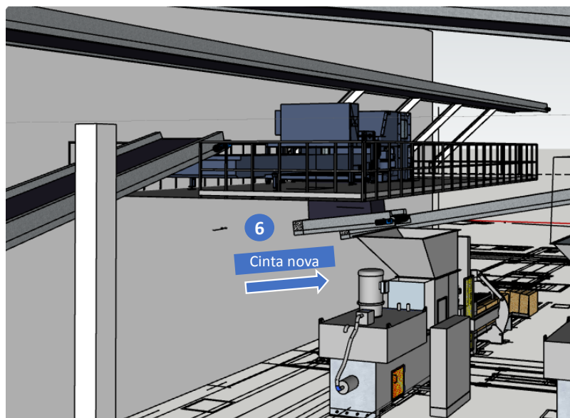
Figura 21. Vistes inferior-lateral del separador òptic i de la cinta de recepció de producte final recollit en negatiu (cinta nº6) per a l'alimentació de la tremuja de la premsa. Cada imatge mostra una solució d'implementació segons la orientació de la cinta nº6, longitudinal o transversal.
