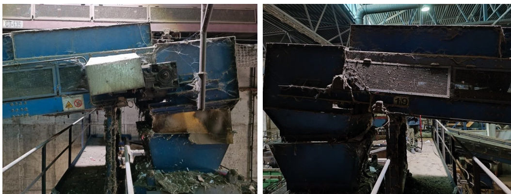
Figura 14. Vistes laterals de la cinta i la tremuja d'alimentació de la premsa multi-material n°1.
