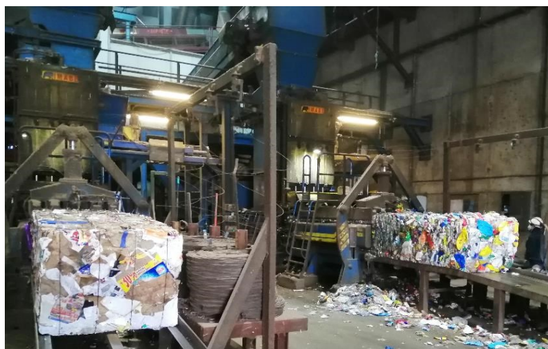
Figura 17. Imatge del conjunt de tremuja i premsa multi-material n°1 (dreta), sobre el qual s'instal·larà el nou separador òptic d'impureses.
