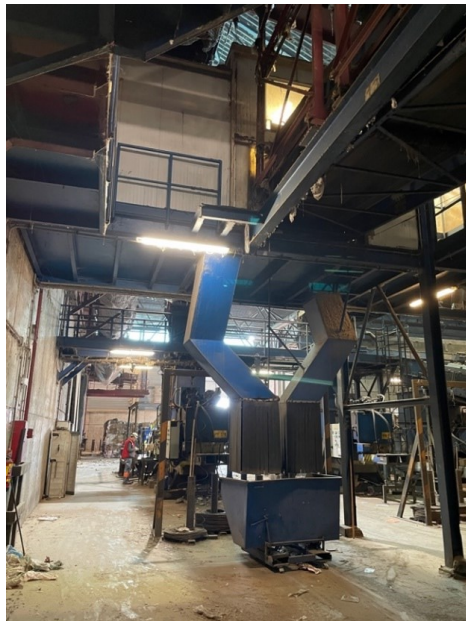
Figura 16. Cabina de control de qualitat manual CB-183, contenidor d'impropis (situat sota la cabina) i Cinta CT-175 d'alimentació a la premsa.
