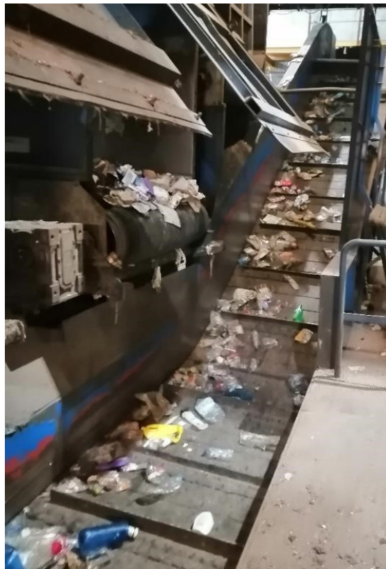
Figura 8. Seqüència de buidatge del dipòsit alimentador de PET a l'alimentador AL-130 i transport de materials cap a la cinta superior CT-175, on es realitza el control de qualitat manual previ a la descàrrega a les tremuges de dues premses multi-material.
