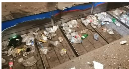
Figura 8. Seqüència de buidatge del dipòsit alimentador de PET a l'alimentador AL-130 i transport de materials cap a la cinta superior CT-175, on es realitza el control de qualitat manual previ a la descàrrega a les tremuges de dues premses multi-material.
