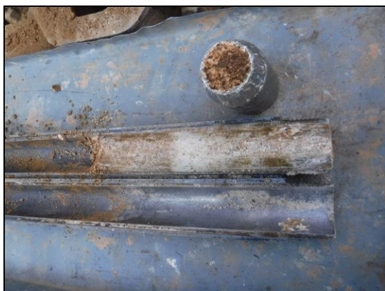
Foto 7: Sondage S-2, SPT a 5,8 metres.
