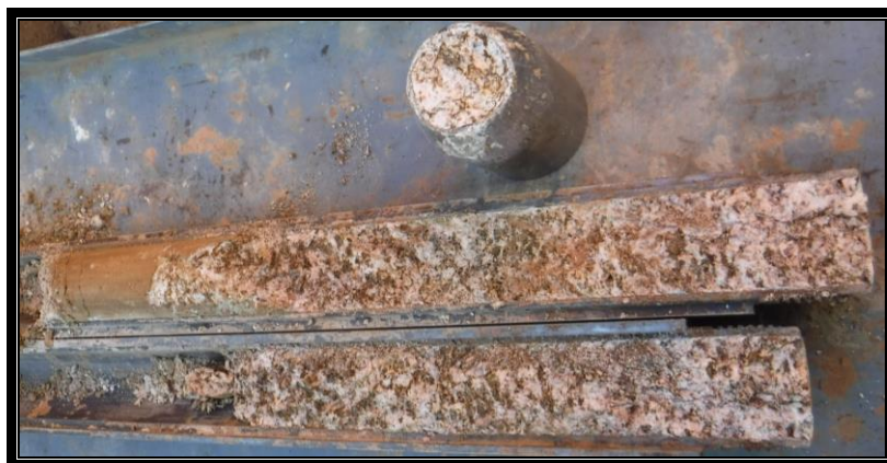
Aspecte dels materials de la capa B recuperats a l'assaig SPT.
