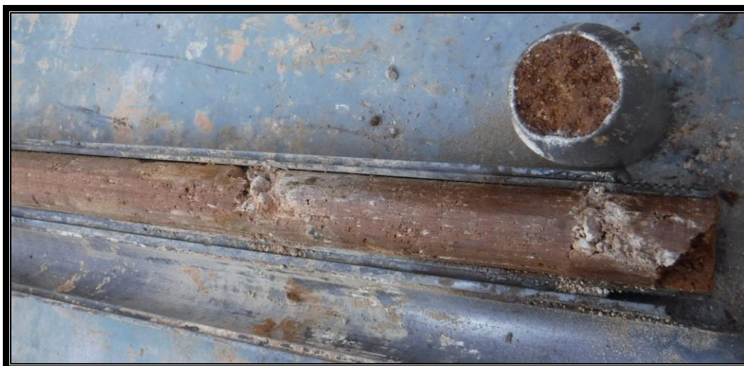
Aspecte dels materials de la capa A recuperats a l'assaig SPT.
