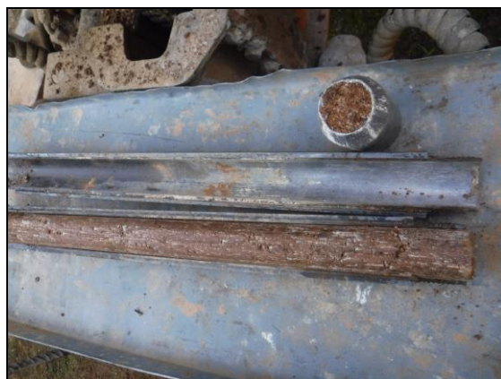
Foto 6: Sondeig S-2, SPT a 3,2 metres.
