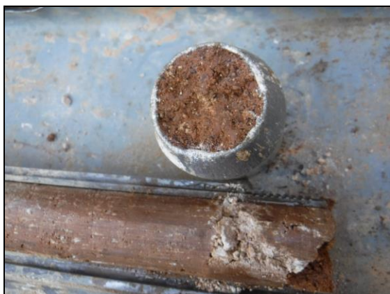
Foto 5: Sondeig S-2, SPT a 1,3 metres.
