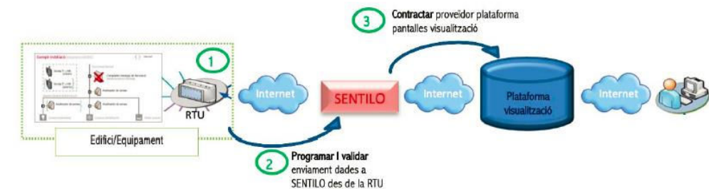
ESQUEMA DE MONITORITZACIÓ. FONT: PROTOCOL DE MONITORATGE ENERGÈTIC AEB
