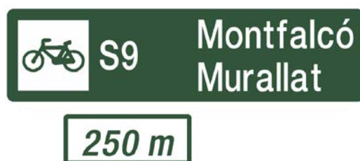
Figura 7.4 Plafó de presenyalització en antenna situat a 250 m abans del punt de decisió
