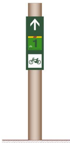
Figura 7.2 Plafó simplificat en posició vertical aprofitant suport existent
