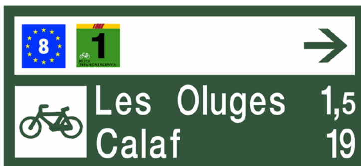
Figura 8.13 Incorporació de mencions amb les distàncies corresponents en un plafó de direcció final
