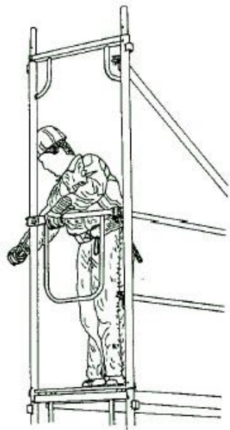
Figura 21. Col·locació de baranes cantoneres.
