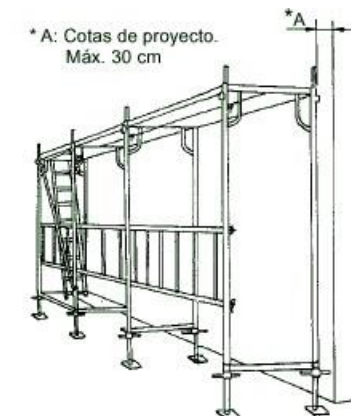
Figura 14. Encadenat de la bastida i comprovació de la separació de la façana
