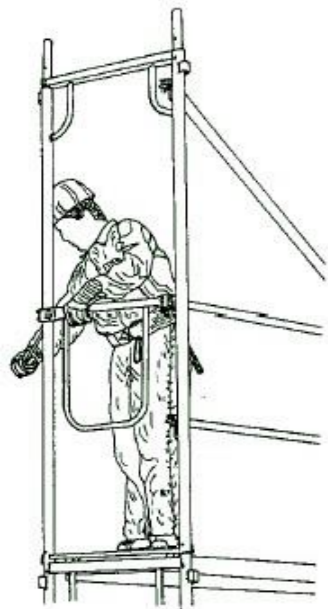
Figura 21. Col·locació de baranes cantoneres.
