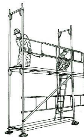
Figura 19. Muntatge de la resta de la bastida
