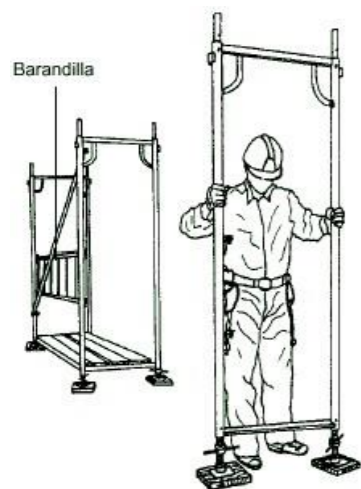
Figura 11. Col·locació de les baranes i posicionament del següent suplement
