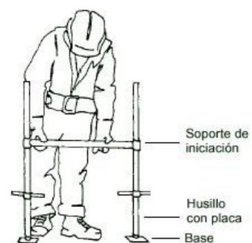
Figura 6. Introducció del suport d'iniciació en les tijes amb placa
