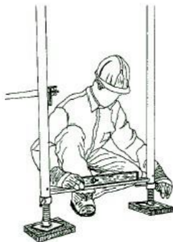
Figura 16. Comprovació de l'anivellació horitzontal
