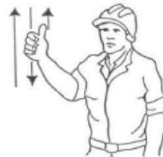
4 Levantar el aguilón o pluma lentamente
