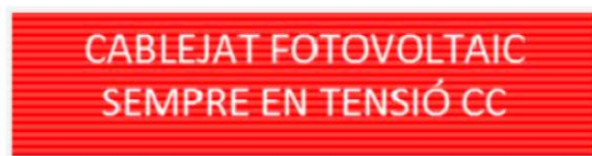
Figura 16. Senyalització cablejat CC. Font: Bombers de Barcelona.
