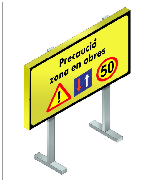
Senyalització obres: Precaució, zona en obres
