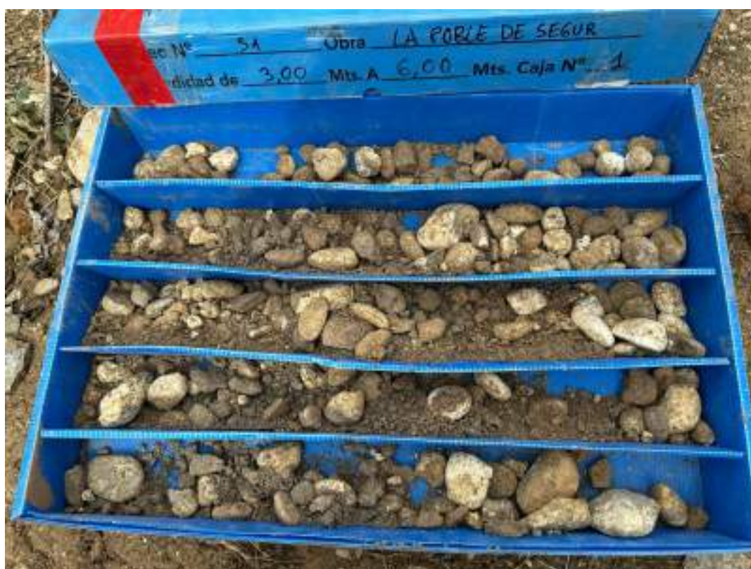
Fotografia de detall de la recuperació del material de la fondària de 3 m a 6 m.
