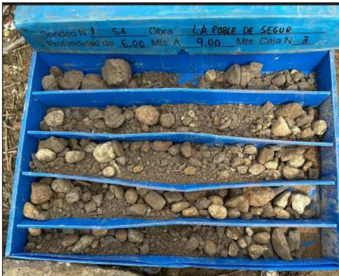
Fotografia de detall de la recuperació del material de la fondària de 6 m a 9 m.
