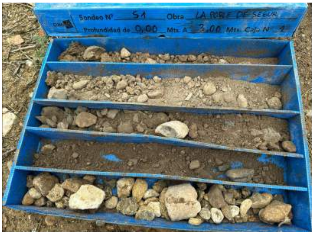
Fotografia de detall de la recuperació del material de la fondària de 0 m a 3 m.
