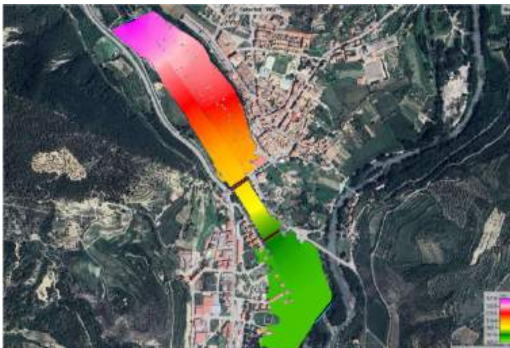
Figura 22. Taca general d'elevació de la làmina d'aigua per a un període de retorn 500 anys
