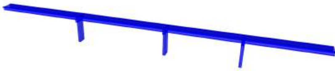
Figura 2. Model introduït al programa de càlcul de micropilots i vibració.
