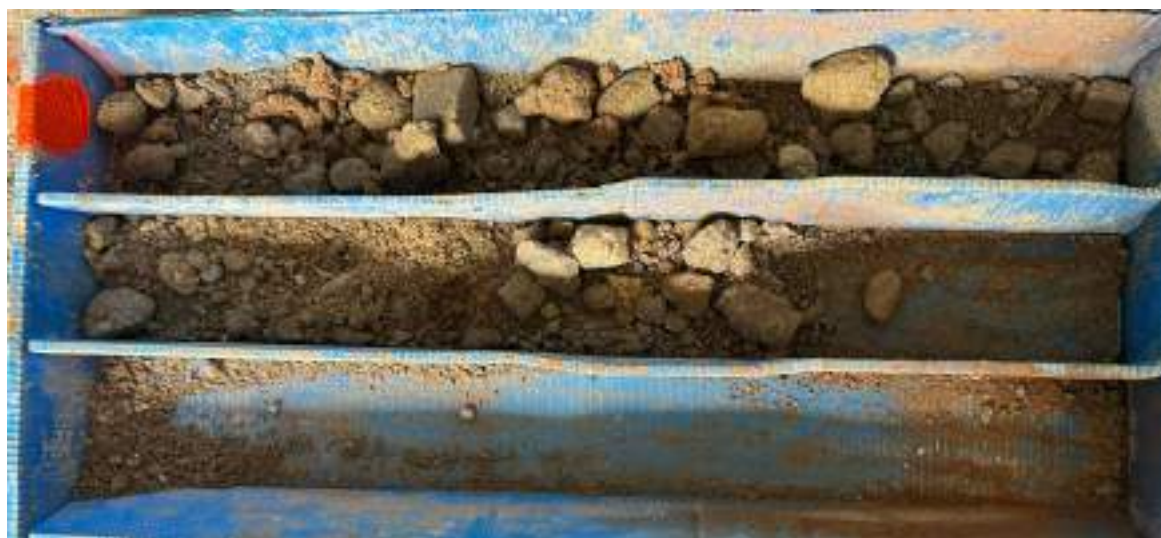
Fotografia de detall de la recuperació del material de la fondària de 9 m a 10 m.
