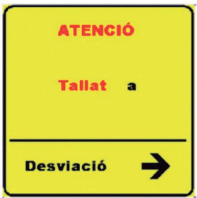
Pancartes i pals tubulars metàl·lics Fons groc, lletres negres Alçària: 150 mm mínim. Lletre Helvetica Medium Condensed. Tall vermell. Mida de pancartes: 1,75x1,75 m (habitualment), 1x1 m o 1,4x1,4 m (en carrers estrets) i 2,1x2,1 m (a rondes).
