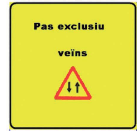
Pancartes i pals tubulars metàl·lics Fons groc, lletres negres Alçària: 150 mm mínim. Llettra Helvetica Medium Condensed. Tall vermell.
