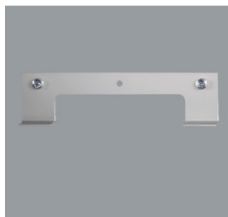
79501.000 Puente de suspensión para uniones de railes rectas. Metal, galvanizado. El puente de suspensión puede montarse retroactivamente desde arriba en el rail electrificado de ERCO. Carga 20kg. L 180mm, H 47mm.
