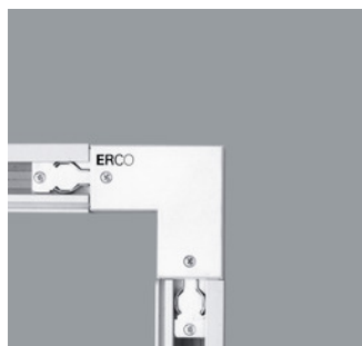
79306.000 Conexión angular trifásica Material sintético. Tierra interior. Alimentación posible. Cableado continuo. Blanco
