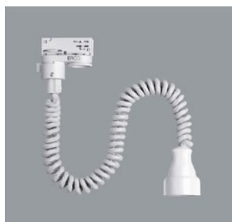
79053.000 Adaptador trifásico ERCO con acoplamiento Schuko. 250V, 6A. Cable espiral 3x0,75mm 2 . L 700/1400mm. Blanco
