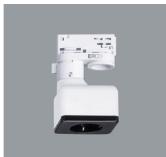
79023.000 Adaptador trifásico ERCO con enchufe Schuko. 250V, 10A. Material sintético. Cubierta superior: material sintético, negro. L 71mm, B 56mm, H 90mm. Blanco
