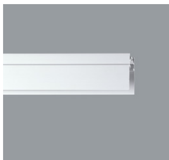
78350.000 Perfil de montaje Perfil de aluminio, plateado anodizado. Para el montaje enrasado de railes electrificados en falsos techos. B 40mm, H 52mm, L 3000mm. Peso 3,00kg
