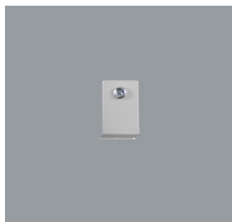
79500.000 Suspensión para railes electrificados Metal, galvanizado. La suspensión puede montarse retroactivamente desde arriba en el rail electrificado de ERCO. Carga 15kg. L 30mm, H 47mm.
