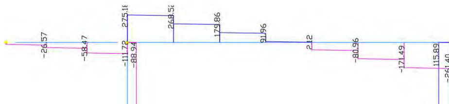
Imatge 8-8. Representació del diagrama de tallants de la jàssera tipus
