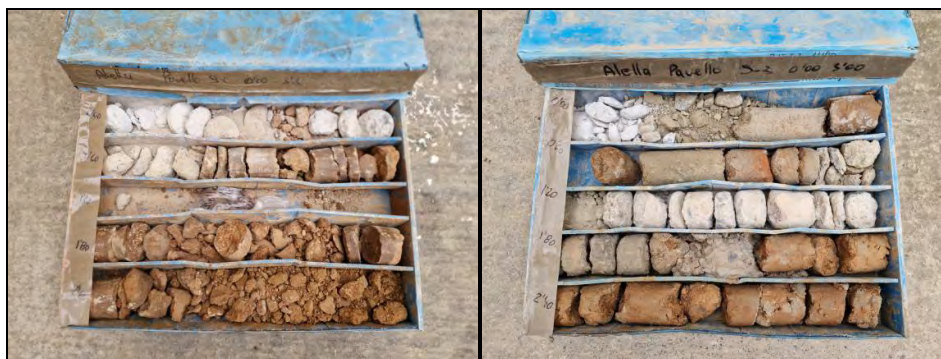
Imatge 4-1. Nivell 0 de paviments i reblerts argilosos. En el S-2 s'observen els diferents paviments.
