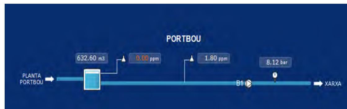
Figura 15 - Telecontrol del volum del dipòsit de Portbou.
