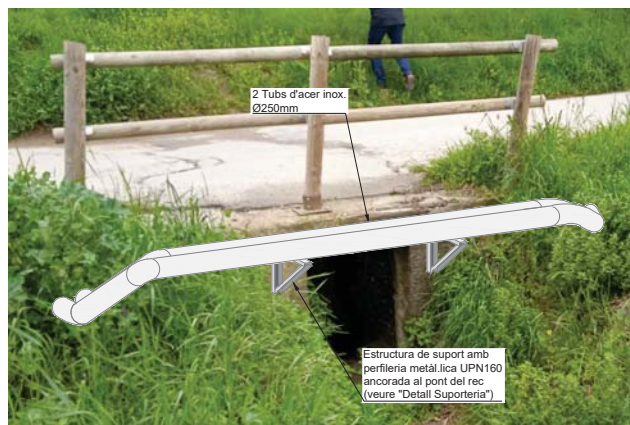
DETALL A: Pont de rec (Castelló d'Empúries)
