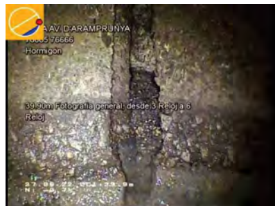
26648_17d8bc45-3b4d-490b-baf3-cc0b89febb5f_20220627_145637_128.jpg, 00:04:34, 39.90 Fotografía general, desde 3 Reloj a 6 Reloj / JUNTA ABIERTA
