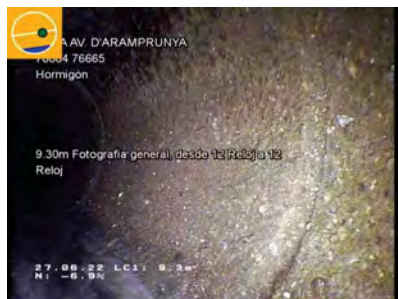
26647_86373d1a-2209-4006-800b-1fb2c0cbe7ce_20220627_143528_452.jpg, 00:00:47, 9.30 Fotografía general, desde 12 Reloj a 12 Reloj / DESGASTE
