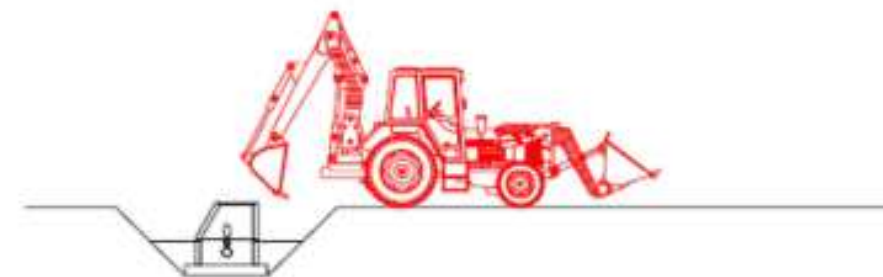
6. Reblert del pou amb retro-excavadora en longades
