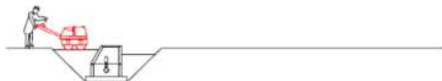
7. Compactació de terres al voltant del pou
