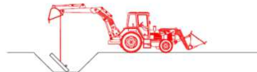
3. Col·locació de la base del pou
