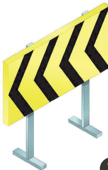
1. plafó desviament de trànsit
