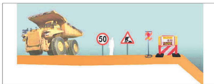
Esquema protecció i senyalització de desmunt i terraplens
