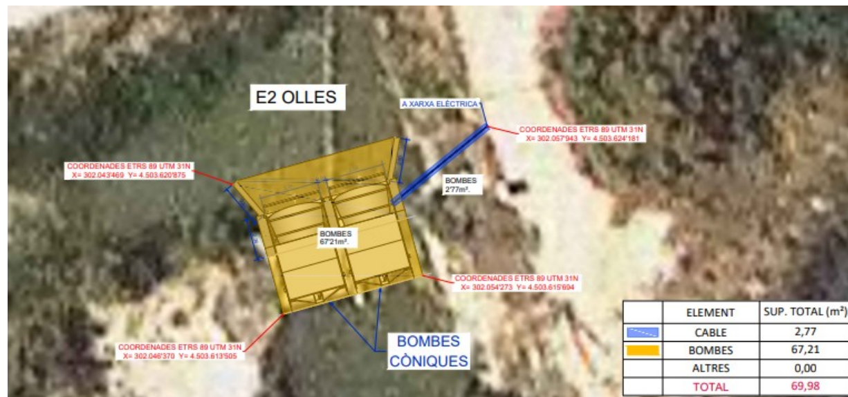
Figura 7.- Nou sistema de bombeig E2 Olles.
