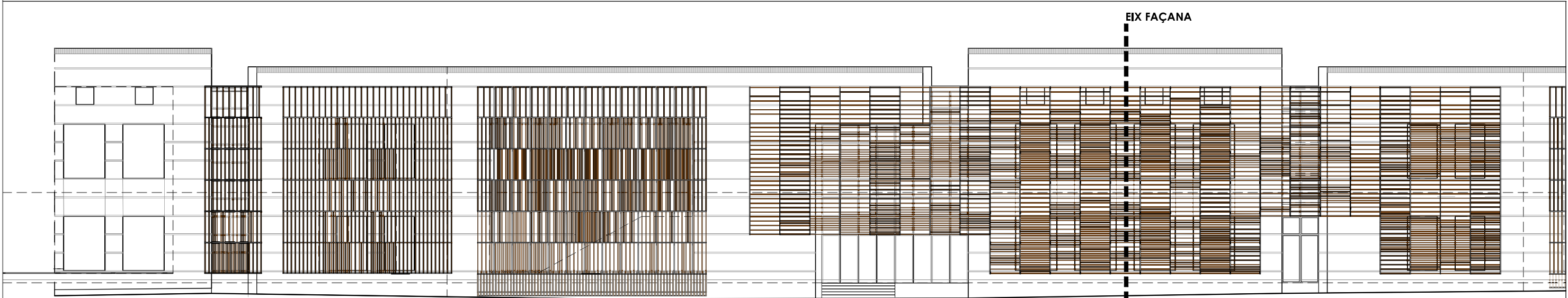
PROTECCIONS SOLAR S FAÇANA DESPLEGADA PONENT
