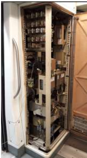
Armari BT1 del cotxe motor MB2 (foto esquerra) on es troba el PC industrial de la solució Digital Train, i detall del mateix (foto dreta).
