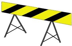
VALLA DE OBRA MODELO 2
