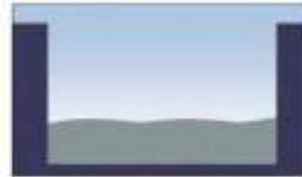
Hacer una solera de hormigón adecuado a la capacidad y dimensiones del Fire Tank Compact, vertiendo en la excavación hormigón de resistencia H25 (250Kg/cm<sup>3</sup>), con mallazo de 15x15x10 con una altura de 25 cm.
