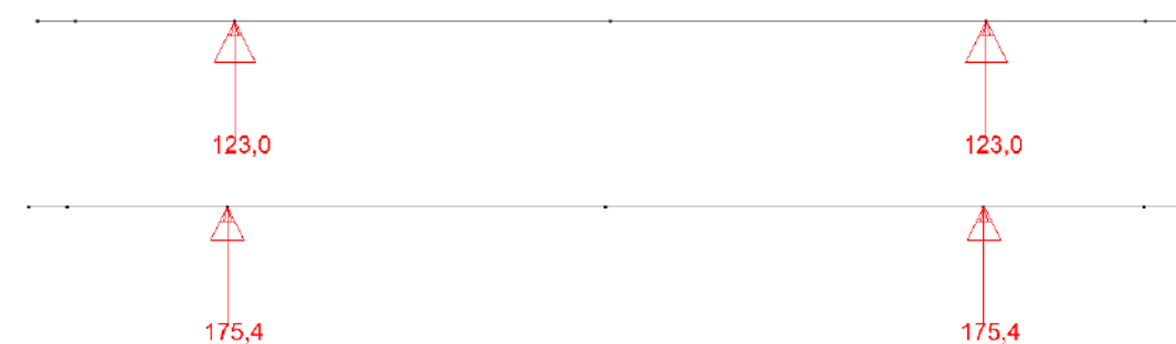
Reacció màxima al micropiló, en kN (ELS i ELU)
