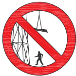
PROHIBIT DE TRANSITAR SOTA CARREGUES SUSPESSES
