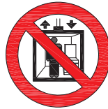
PROHIBIT D'ELEVAR PERSONES
