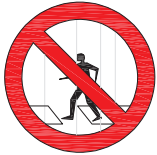
PROHIBIT EL PAS BASTIDA INCOMPLET
