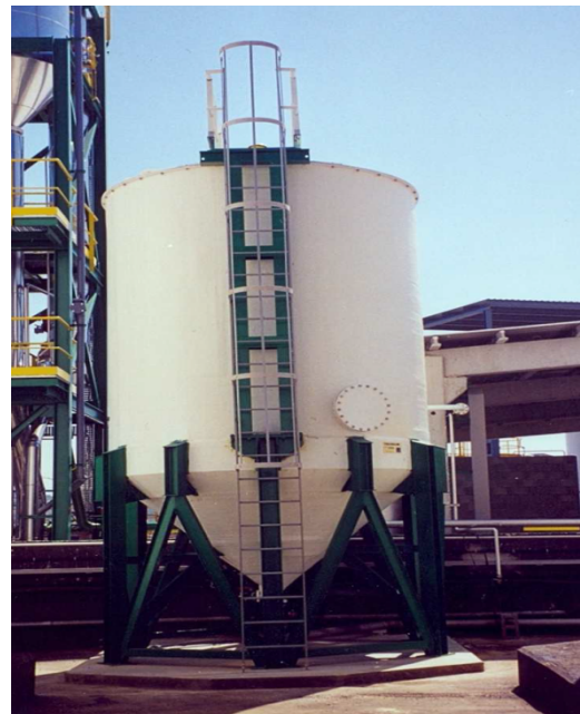
Foto 70: Exemple d'espessidor de fangs nou.
