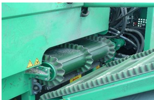
Detall del procés d'enrotllat de la gespa artificial
