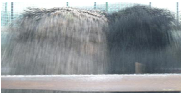
Detall de la separació dels reblerts de sorra i cautxú i del cribratge per vibració
