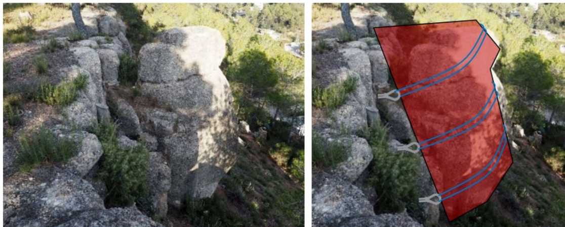
Fig. 29. Bloc inestable a la cinglera del sector B (esquerra) i actuació directa AD3 il·lustrativa amb faixes i xarxa de cable i ancoratges (dreta).
