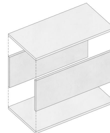
Fabricació de l'estructura mitjançant panells simples
