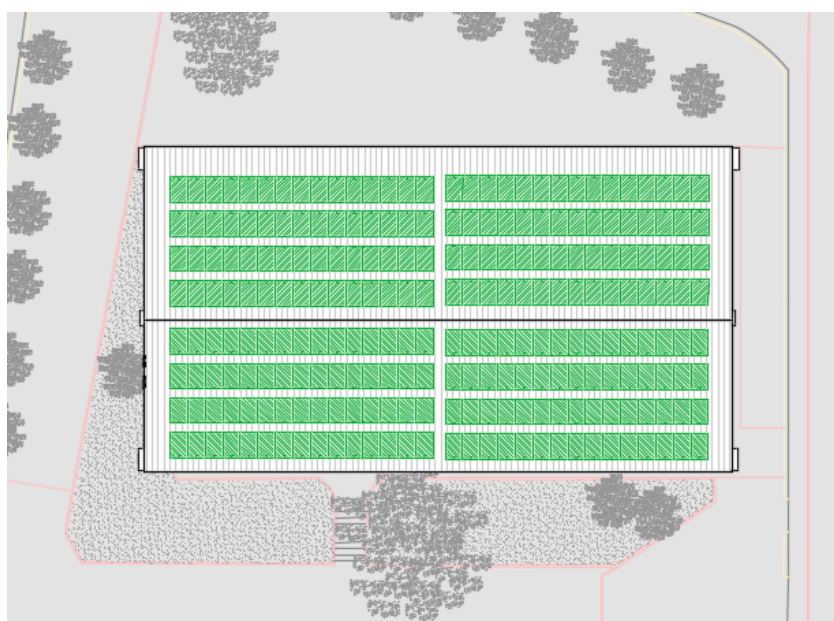
Figura 4. Distribució del camp fotovoltaic.
