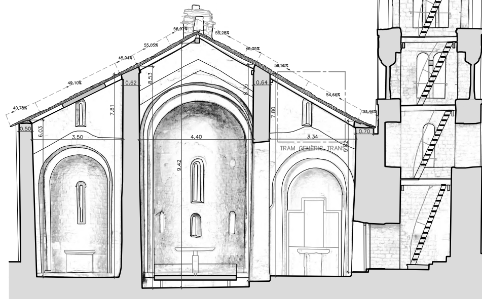
SECCIÓ TRANSVERSAL ESTAT ACTUAL NAU_B-B'
