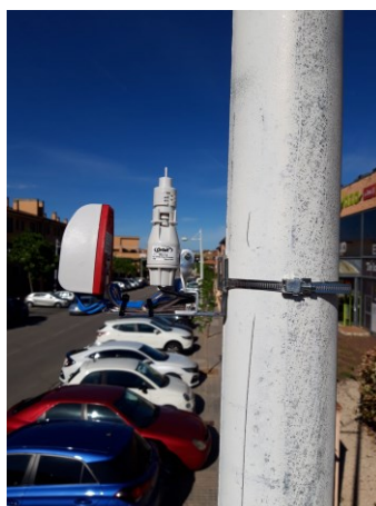
Exemple d'instal·lació d'un Concentrador + Router amb el sensor de pluja
