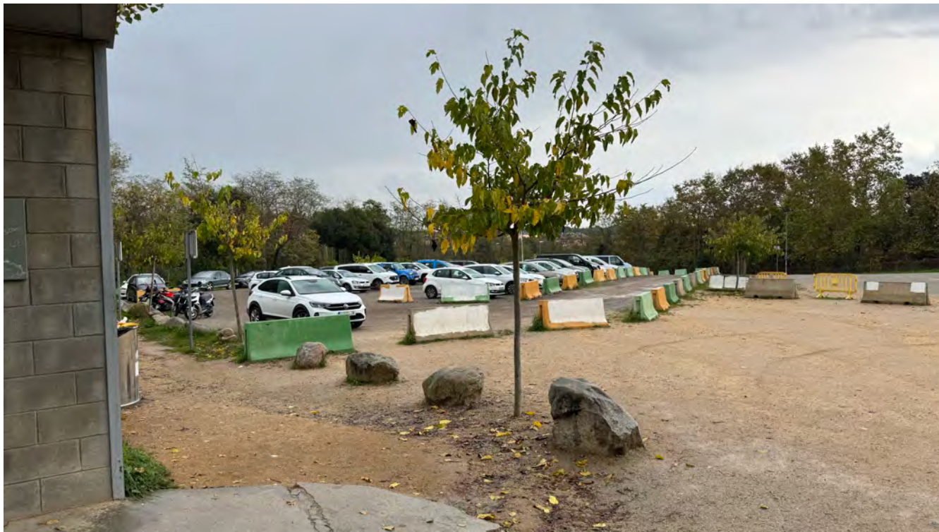
Vista des de l'entrada de l'Institut Vilamajor. En primer terme es pot observar que la zona propera a l'accés està formada per una capa de sauló. En segon terme els vehicles aparcats, separats per tanques de formigó del tipus New Jersey.
