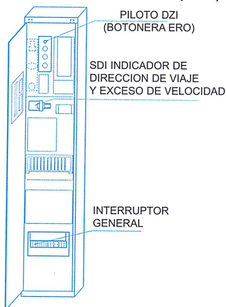
CUADRO EN ÚLTIMA PLANTA (ASCENSORES SIN CUARTO DE MÁQU.)
