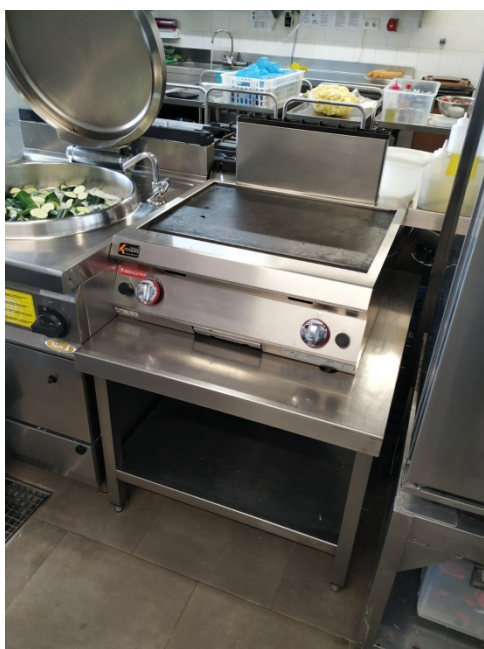
Placa de cocció multi-funció marca ANGELOPO amb estructura d'acer inoxidable AISI 304, part superior de 20/10 mm de gruix.
