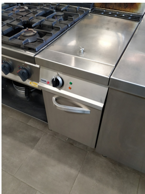
Fregidora a gas de dues cistelles de la marca FAGOR gama KORE 700 de dimensions 0,40x0,90x0,8m.
