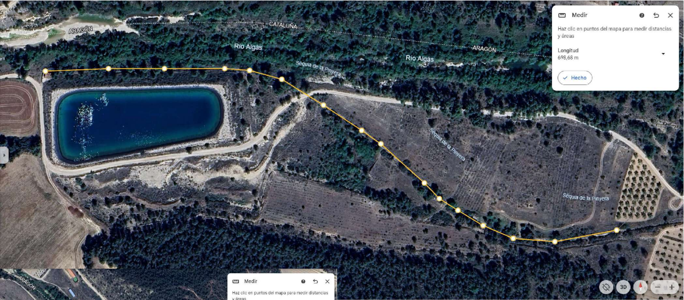
Tram 1: 360 m substitució de canonada amb tub PE 315 PN6
