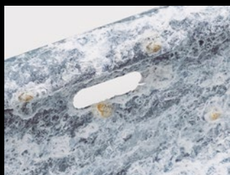
Acabado galvanizado en caliente estándar después de 700 horas Standard hot dip galvanized finish after 700 hours
