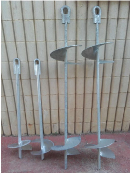
SISTEMA D'ANCORATGE EN FONTS TOUS I EN FONTS AMB POSIDONIA
