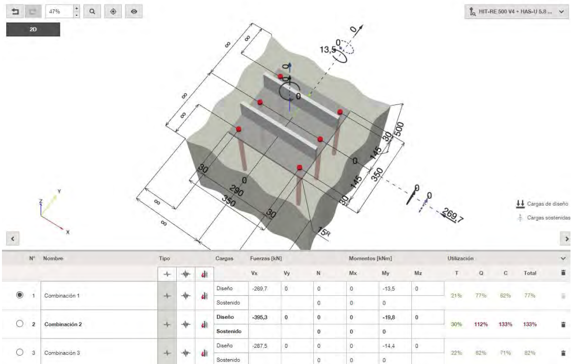
Figura 9. Detalle de cálculo de anclajes (placa colocada en obra)
