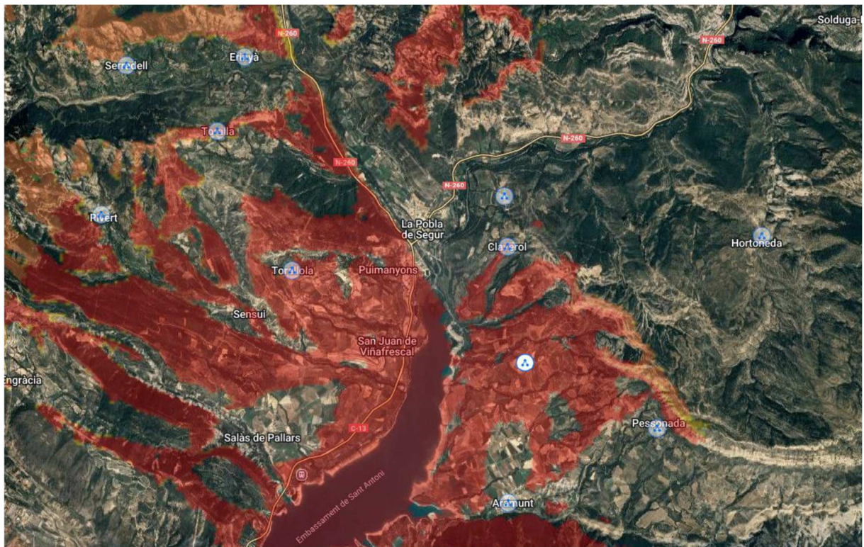
Simulació del mapa de cobertura amb l'antena instal·lada a Sant Martí de Canals
