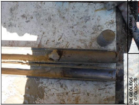
Foto 10: Sondeig S-2, SPT a 15,3 metres.
