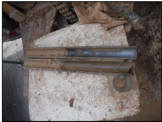
Foto 9: Sondeig S-2, SPT a 10,2 metres.
