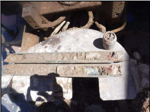
Foto 3: Sondeig S-1, SPT a 5,4 metres.
