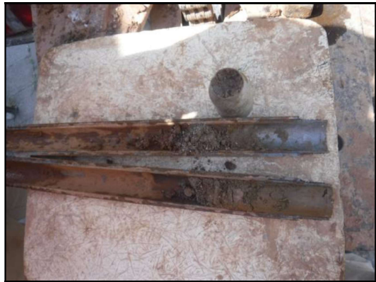
Foto 7: Sondeig S-2, SPT a 3,2 metres.
