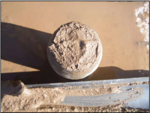
Foto 5: Sondeig S-1, SPT a 14,8 metres.
