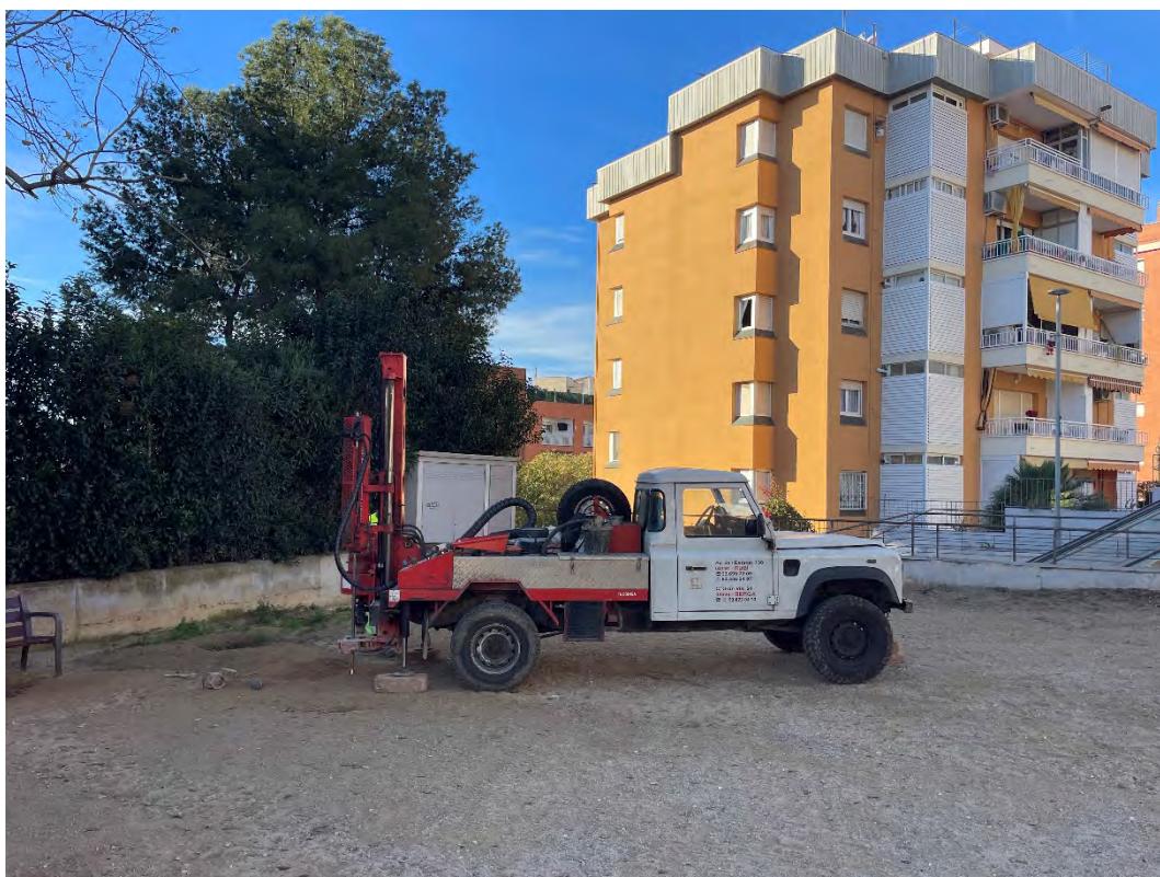
Sondeigs de penetració dinàmica DPSH-4
