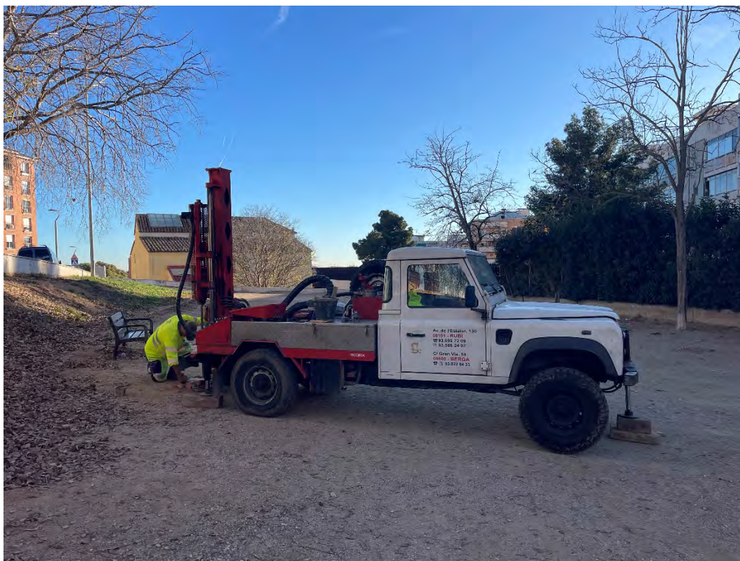
Sondeigs de penetració dinàmica DPSH-3
