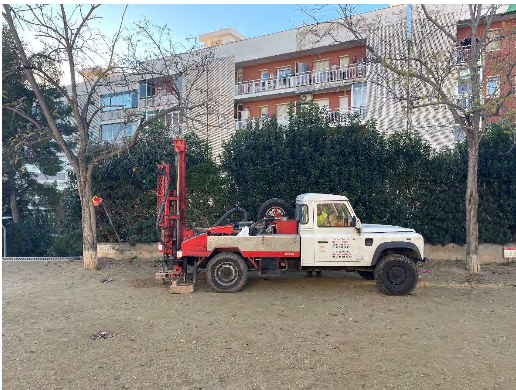
Sondeigs de penetració dinàmica DPSH-2
