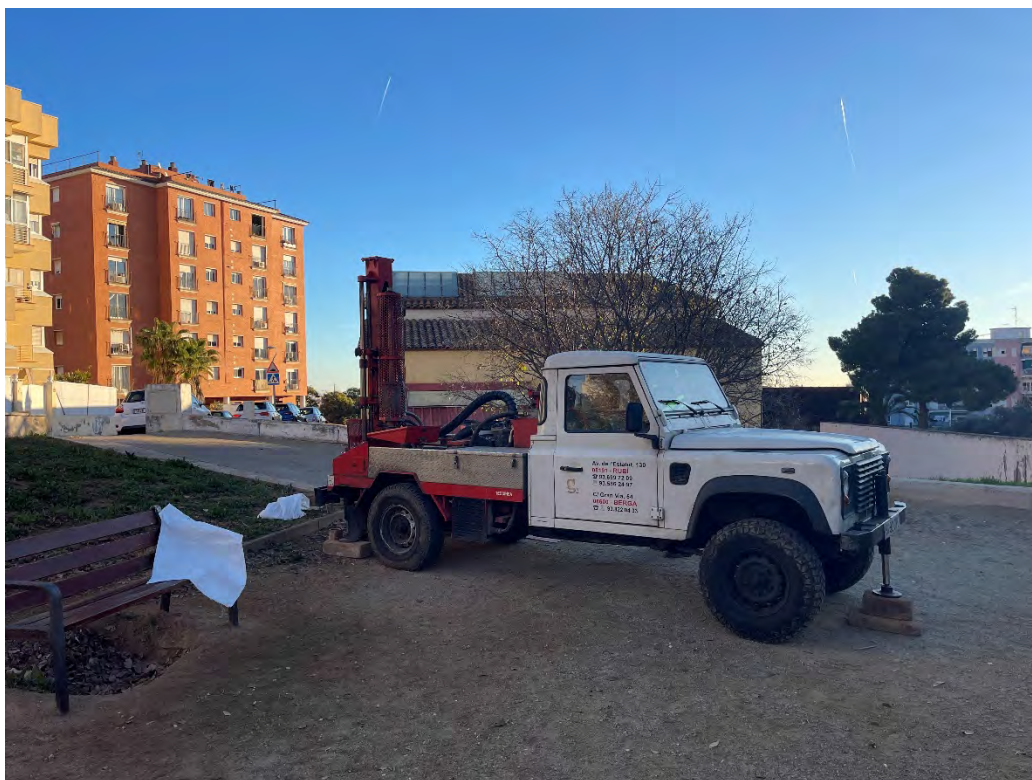
Sondeigs de penetració dinàmica DPSH-1
