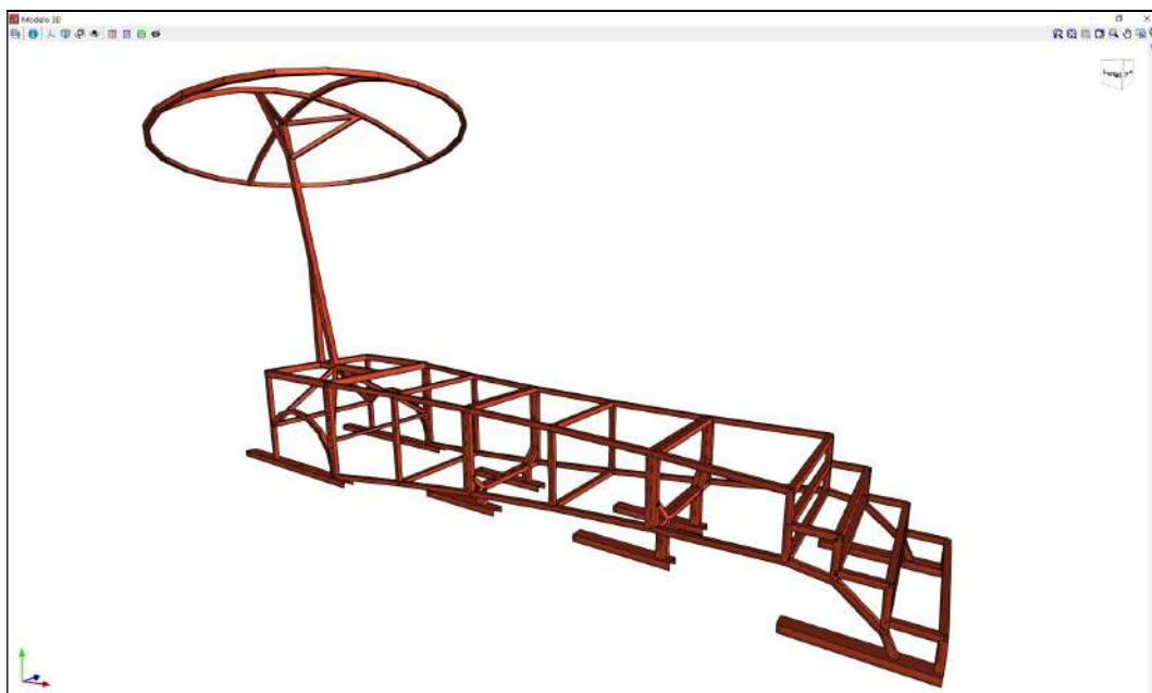
Imatge del model càlcul generat amb CYPE 3D per dimensionar l'estructura de la carrossa
