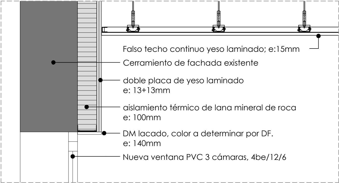
TRASDOSADO INTERIOR TIPO 1 e:126mm (100+13+13)
