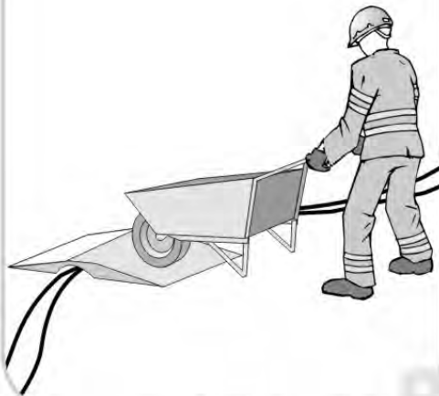
protección de conductores
