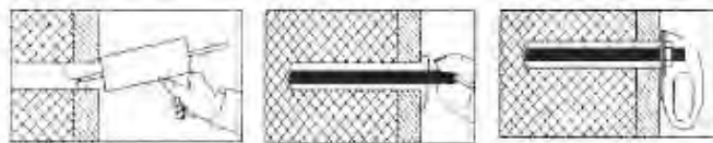
Figura 12 Esquema de colocación de anclajes químicos
