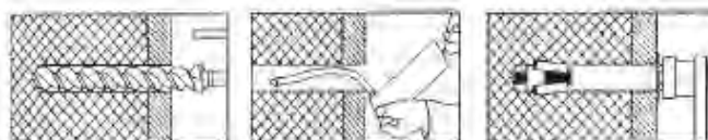
Figura 11 Esquema de instalación de un tipo de anclaje mecánico
