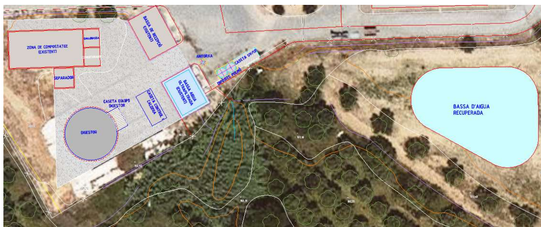
Figura 2: Distribució general de la Planta de Biogàs.
